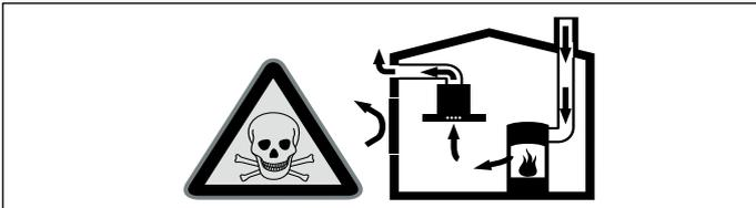
Ildsteder som er avhengige av romluft (f.eks. varmeapparater som drives med gass, olje eller kull, varmtvannsberedere), bruker forbrenningsluften fra oppstillingsrommet og leder avgassene gjennom et avgassanlegg (f.eks. avtrekkskanal) ut i det fri.
