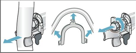
4. Вийняти мережевий кабель з кріплень. Вийняти втулки.
