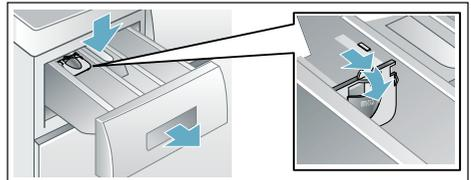
**Вказівка:** Не використовуйте дозатор для завантаження прального гелю й порошку, а також для програм із замочуванням/попереднім пранням або вибраною функцією «Час до завершення».
