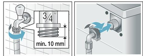
Обережно відкрити водопровідний кран і перевірте щільність в місцях з'єднань.
