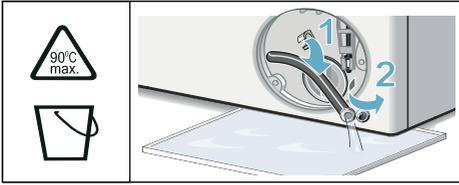
5. Обережно відкрутіть кришку насоса — можуть витікати залишки води. Очистьте внутрішні поверхні насоса, нарізь кришки і корпус насоса. Робоче колесо насоса для прального розчину має вільно обертатися. Установіть на місце і закрутіть кришку насоса. Ручка повинна знаходитися у вертикальному положенні.
