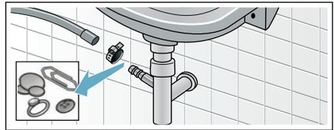
4. Вставте знову зливний шланг та закріпіть місце з'єднання за допомогою затискача шлангу.
