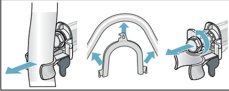
4. Вийняти мережевий кабель з кріплень. Вийняти втулки.
