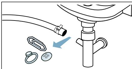
2. Das Sieb mit einer Zange entfernen.
