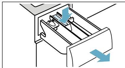
2. Dosierhilfe nach vorn schieben, herunterklappen und einrasten.
