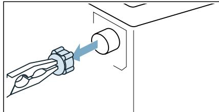
4. Die Ablaufschlauch wieder aufstecken und die Anschlussstelle mit der Schlauchschelle sichern.
