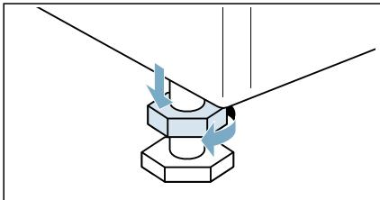
2. Ausrichtung des Geräts mit Wasserwaage überprüfen, evtl. korrigieren. Höhe durch Drehen des Gerätetfußes verändern.
