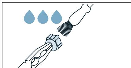
4. Den Schlauch anschließen und auf Dichtheit prüfen.
