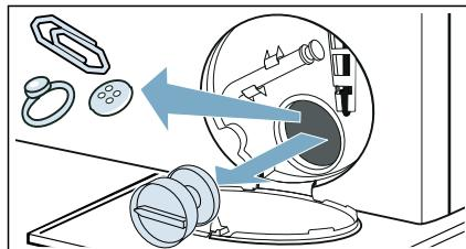
5. Den Pumpendeckel wieder einsetzen und anschrauben. Der Griff muss senkrecht stehen.
