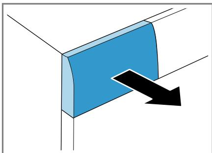
4. Das Pulvervollwaschmittel in die Kammer II einfüllen.
