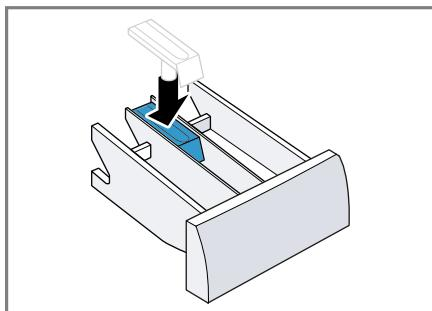
6. Die Öffnung für die Waschmittelschublade reinigen.
