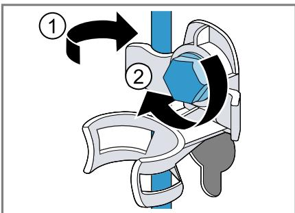
**5. Den Schlauch in die Halterung einsetzen.**
