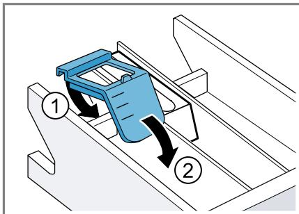
3. Die Waschmittelschublade einsetzen.
