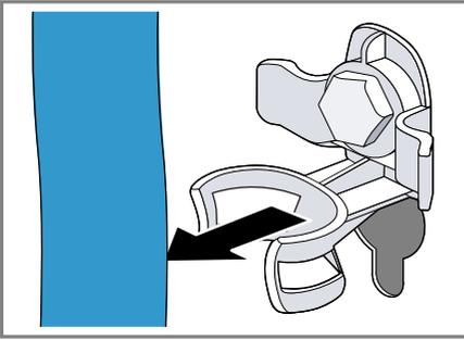
2. Всичките 4 винта на транспортните обезопасявания се развират ① и свалят с ② гаечен ключ SW13.
