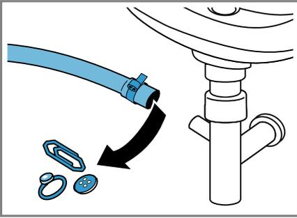
5. Пъхнете маркуча за мръсна вода и обезопасете местата на свързване със скобата за маркуч.
