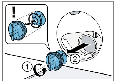
2. Почистете вътрешността, резбата на капака на помпата и корпуса на помпата.
