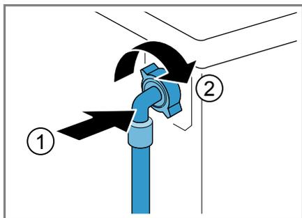
2. Свържете маркуча за с вода към водопроводния кран (26,4 мм = 3/4").
