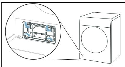
4. Wärmetauscher-Abdeckung am Griff herausziehen.
