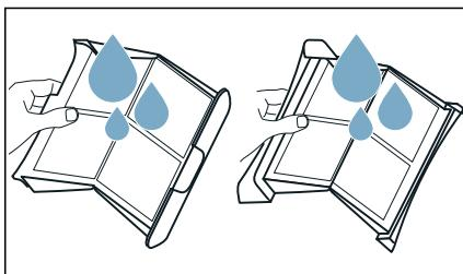
8. Flusensiebe abtrocknen, zuklappen und wieder einsetzen.
