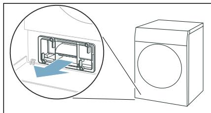
5. Filtermatte vorsichtig von der Wärmetauscher-Abdeckung ziehen.
