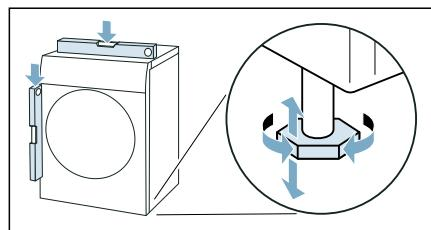
3. Falls notwendig, Gerät neu ausrichten durch Drehen der Gerätetfüße. Sie können das Gerät jetzt anschließen.
