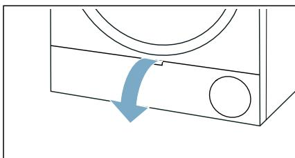
3. Hebel der Wärmetauscher-Abdeckung entriegeln.
