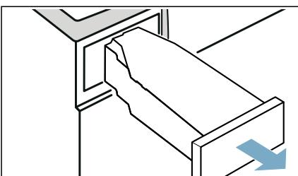
2. Kondenswasser-Behälter bis zum fühlbaren Einrasten wieder in das Gerät schieben.
