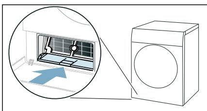
10. Wärmetauscher-Abdeckung am Griff einschieben.
