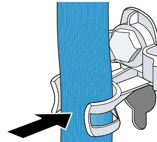
3. Alle Schrauben der 4 Transportsicherungen einsetzen und leicht anziehen.
