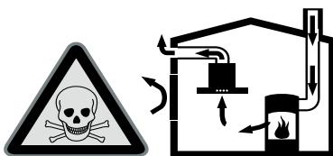
Vatrišta koja zavise od vazduha u prostoriji (npr. grejni uredaji na gas, ulje, drvo ili ugalj, protočni bojleri, kotlovi za zagrevanje vode) vazduh za sagorevanje crpe iz prostorije u koju su postavljeni i izduvne gasove izbacuju preko sistema za izduvne gasove (npr. kamin) u spoljašnju sredinu.
