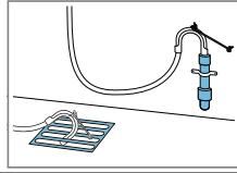
Fissare il tubo flessibile di scarico dell'acqua con un collettore.
