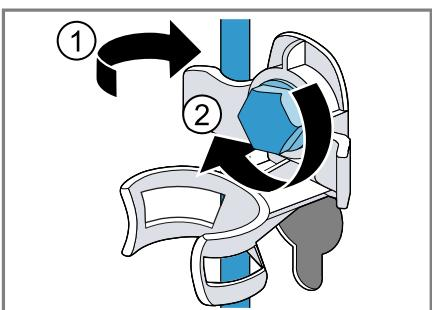
**5. Inserire il tubo flessibile nell'alloggiamento.**
