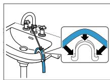
Fissare e assicurare il tubo flessibile di scarico dell'acqua con un collettore.
