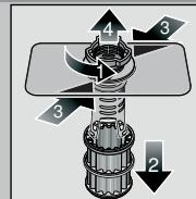
Rodar o filtro cilíndrico
