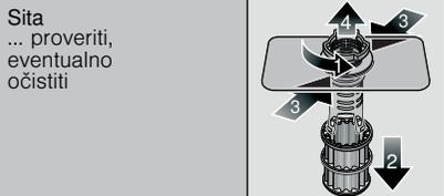
Odvrti cilindar sita, sistem sita izvaditi ...
