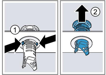
5. Limpiar los elementos filtrantes bajo el chorro de agua del grifo. Limpiar con cuidado el borde de suciedad entre el filtro grueso y el filtro fino.
