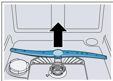
3. Comprobar si hay obstrucciones en las boquillas de salida de los brazos de aspersión bajo el chorro de agua del grifo y, en caso necesario, retirar los cuerpos extraños.
