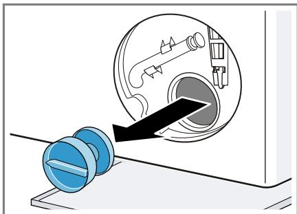
2. Očistite unutarnji prostor, navoj na poklopcu crpke te kućište crpke.
