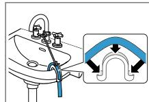
2. Dovodno crijevo za vodu priključite na slavinu za vodu (26,4 mm = 3/4").
