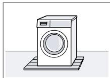
Uredaj postavite na drvenu ploču otpornu na vodu koja je vijcima pričvršćena za pod. Drvena ploča mora biti debljine najmanje 30 mm.
