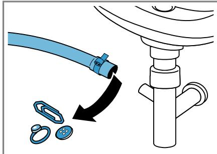
5. Nataknite odvodno crijevo za vodu i priključno mjesto osigurajte obujmicom crijeva.
