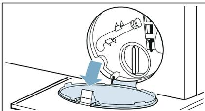
3. Retire a mangueira de escoamento do retentor. Remova a tampa de vedação e verta a água para um recipiente adequado. Substitua a tampa de vedação e recoloca a mangueira de escoamento no retentor.
