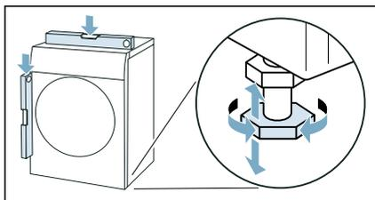
3. Aperte a porca de bloqueio contra a caixa. Ao fazê-lo, mantenha o pé firme e não ajuste a sua altura. As porcas de bloqueio nos quatro pés do aparelho têm de ser bem aparafusadas à caixa.
