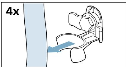
2. Desaperte e remova os quatro parafusos de suporte para transporte.
