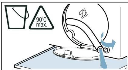
4. Desaparafuse cuidadosamente a cobertura da bomba; poderá sair água residual.
