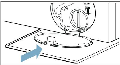
**Conselho:** Para evitar que o detergente não utilizado flua diretamente para o escoamento durante a próxima lavagem: deite 1 litro de água no Dispensador II e inicie o programa (**Drenar**).
