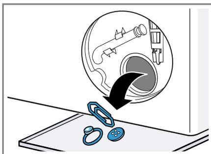
3. Assegure que a roda de pás da bomba de escoamento gira livremente.
