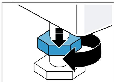
2. Rodar os pés reguláveis para nivelar o aparelho. Verificar o nivelamento com nível de bolha de ar.
