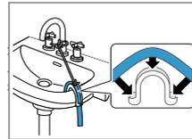
Escoamento para um tubo de plástico com manga de borracha ou para o esgoto.
