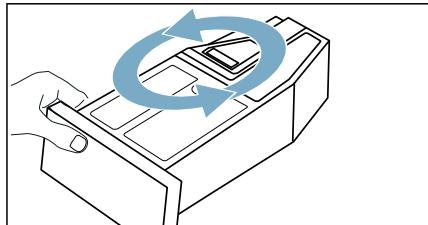
**13. Versare ancora 1 1/2 litro circa di acqua calda del rubinetto nel contenitore della condensa.**
