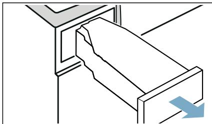
7. Versare nel contenitore della condensa un flacone del prodotto originale per la cura dell'apparecchio insieme a 1 1/2 litro circa di acqua calda del rubinetto.
