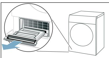
**Avvertenza:** Il vano di deposito della lanugine può contenere lanugine umida e acqua residua e può gocciolare durante l'estrazione.
