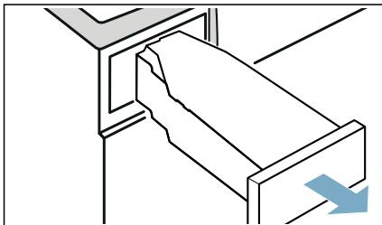
**11. Versare circa 1 1/2 un litro di acqua calda del rubinetto nel contenitore della condensa.**
