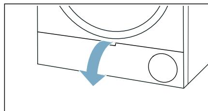
2. Sbloccare la leva del coperchio dello scambiatore di calore.
