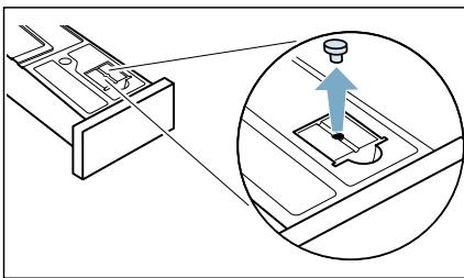
2. Ruotare il contenitore dell'acqua di condensa di 180° e capovolgerlo e inserire il tappo.
