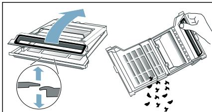
8. Sciacquare abbondantemente sotto acqua corrente il filtro del vano di deposito della lanugine e asciugarlo.
