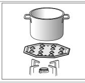
该附件部分仅适用于文火煨。也 可与节能燃烧器或标准燃烧器配 套使用。如果您的灶具有多个标 准燃烧器, 我们建议将炖盘放在 后方或右前方的标准燃烧器上。 将附件组件放在托架上, 凸出部 分朝上: 切勿将其直接放在燃烧 器上。
