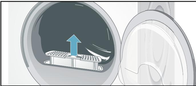
Retirez les peluches de l'ouverture du filtre à peluches et de la zone en dessous. Assurez-vous qu'aucune peluche ne tombe dans l'ouverture ci-dessous.
