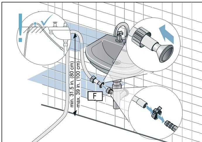
Pour l'installation, la hauteur minimale du drain montré ci-dessus est de 80 cm. (31,4po). La hauteur maximum du drain est de 39 cm.(100 po).
