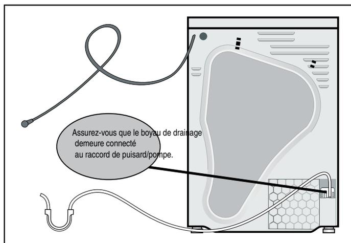
**AVIS :** Ne réutilisez pas un vieux tuyau de drainage ou un tuyau différent. Utilisez seulement le tuyau de drainage livré avec la sècheuse.
