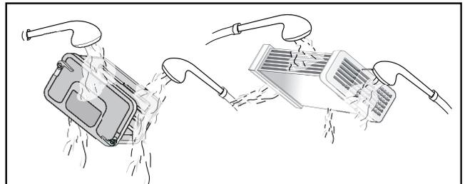
8. Enlevez les peluches et la charpie sur les joints de la sècheuse et du condenseur.
