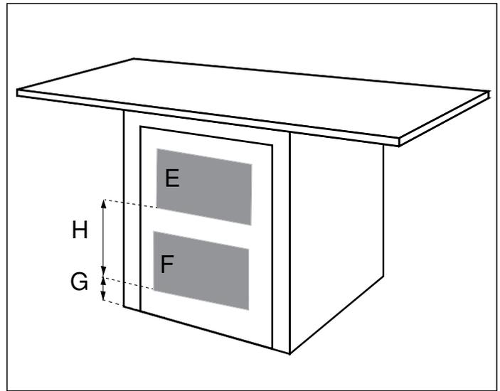
Si le devant de l'appareil électroménager est couvert, prévoyez des ouvertures pour la ventilation.
