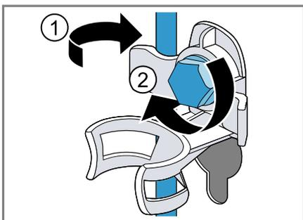
5. Insérez le tuyau dans le support.
