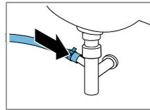
Fissare il punto di collegamento con una fascetta stringitubo (24-40 mm).
