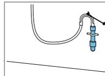
Fissare il tubo flessibile di scarico dell'acqua con un collettore → *Pagina 32*.
