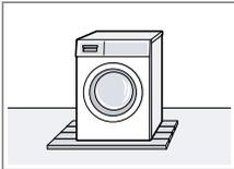
Collocare l'apparecchio su una base di legno resistente all'acqua ben fissata al pavimento. Lo spessore della base di legno deve essere di almeno 30 mm.
