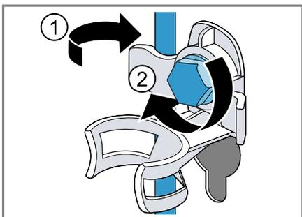
5. Inserire il tubo flessibile nell'alloggiamento.
