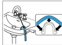
Fissare e assicurare il tubo flessibile di scarico dell'acqua con un collettore → *Pagina 32*.
