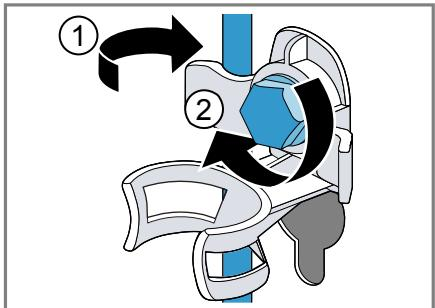
**5. Inserire il tubo flessibile nell'alloggiamento.**
