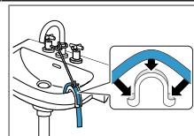
Scarico in un tubo in plastica con raccordo in gomma
