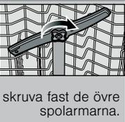
skruva fast de övre spolarmarna.
