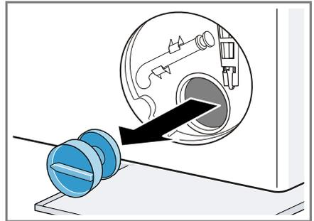
2. Nettoyez le compartiment intérieur, le filetage du couvercle de pompe et le carter de pompe.
