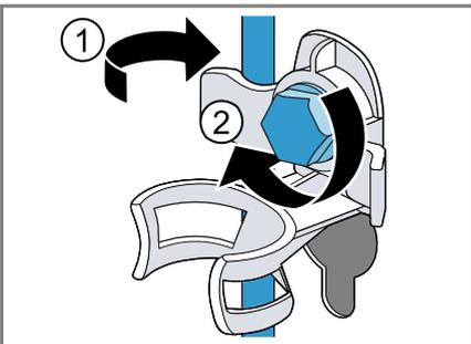
5. Insérez le tuyau dans le support.
