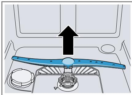
3. Sous l'eau courante, assurez-vous que les buses de sortie des bras d'aspersion sont dégagées et éliminez les corps étrangers au besoin.
