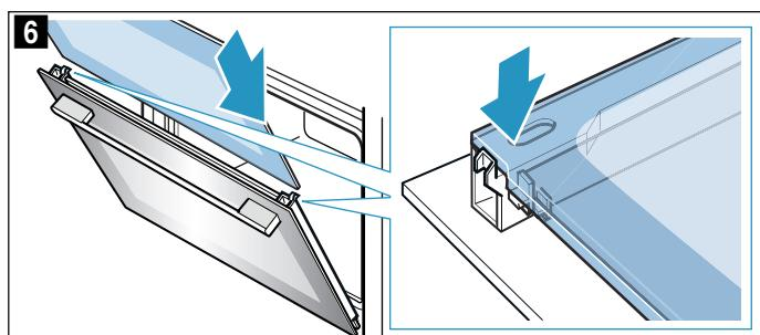
7. Colocar la cubierta y presionar hasta que se oiga que ha encajado (figura 7).
