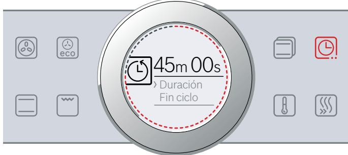
El valor se aplica transcurridos unos segundos o pulsando dos veces el campo . La duración se muestra en pantalla debajo del tipo de calentamiento y la temperatura o del nivel.
