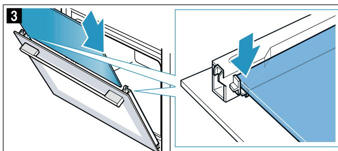
4. Volver a enganchar la junta a izquierda y derecha (figura 4).
