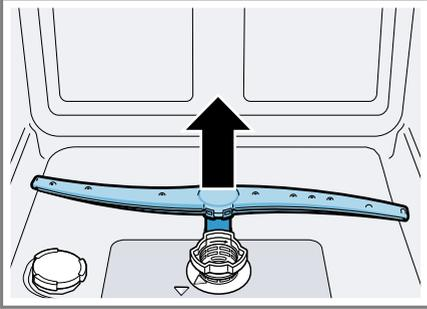
2. Sous l'eau courante, s'assurer que les buses de sortie du bras d'aspersion sont dégagées et éliminer les corps étrangers au besoin.
