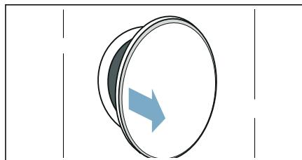
2. Snímač vlhkosti vyčistite zdrsnenou špongiou.
