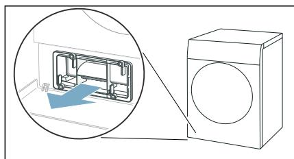
5. Filtračnú vložku opatrne vytiahnite z krytu výmenníka tepla.
