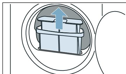
3. Odstráňte vlákna z priehlbiny sitka na vlákna. Dávajte pozor na to, aby do otvorenej šachty nespadli vlákna.
