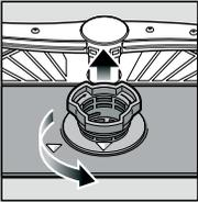
Rodar o filtro cilíndrico e retirar o sistema de filtros ...
