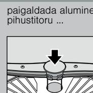
paigaldada alumine pihustitoru ...
