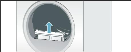
3. Entfernen Sie die Flusen aus der Mulde des Flusensiebes.
