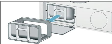
5. Entnehmen Sie den Wärmetauscher.
