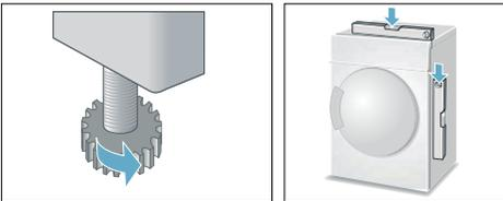
Falsches Ausrichten kann laute Geräusche, Vibrationen und fehlerhafte Trommelbewegungen verursachen.
