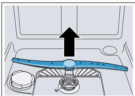
3. Pod mlazom tekuće vode provjerite ima li zaprljanja u izlaznim mlaznicama prskalica i po potrebi ih uklonite.
