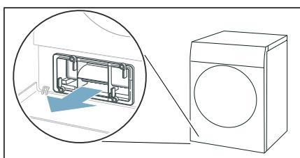
5. Filtermatte vorsichtig von der Wärmetauscher-Abdeckung ziehen.
