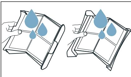
8. Flusensiebe abtrocknen, zuklappen und wieder einsetzen.
