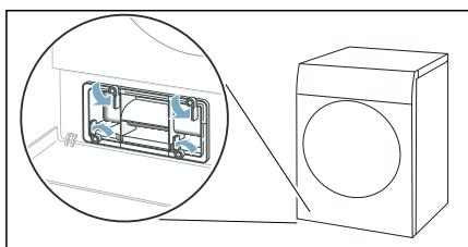
4. Wärmetauscher-Abdeckung am Griff herausziehen.
