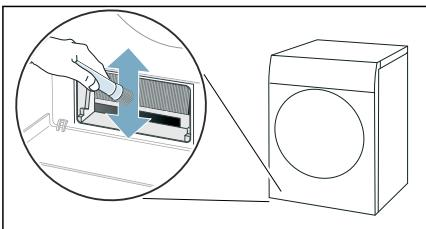
**Hinweis:** Achten Sie darauf, die Lamellen des Wärmetauschers von oben nach unten zu reinigen und nicht zu verbiegen oder zu beschädigen.
