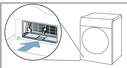
10. Wärmetauscher-Abdeckung am Griff einschieben.
