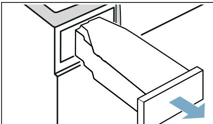
3. Kondenswasser-Behälter bis zum fühlbaren Einrasten wieder in das Gerät schieben.
