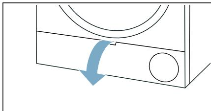
3. Hebel der Wärmetauscher-Abdeckung entriegeln.
