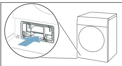
**Hinweis:** Sie können die Wärmetauscher-Abdeckung nur einschieben, wenn sich der Einsatz im Gerät befindet.
