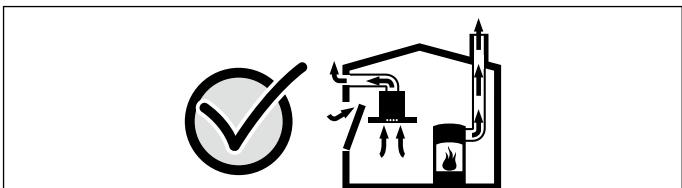
Solicitar siempre asesoramiento al técnico competente de su región, que estará en condiciones de evaluar todo el sistema de ventilación de su hogar y recomendarle las medidas adecuadas en materia de ventilación. Si la campana extractora se utiliza exclusivamente en funcionamiento en recirculación, no hay limitaciones para el funcionamiento.
