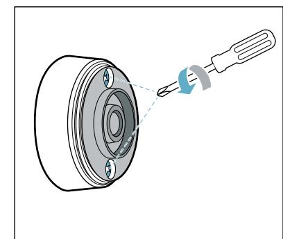
2. Abrir la tapa del Sensor de cocción. Retirar la batería del interior de la base y colocar la nueva batería (seguir las instrucciones de polaridad de la batería).
