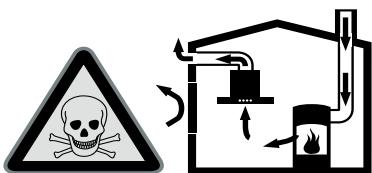
Los equipos calefactores que dependen del aire del recinto de instalación (p. ej., calefactores de gas, aceite, madera o carbón, calefactores de paso continuo, calentadores de agua) adquieren aire de combustión del recinto de instalación y evacuan los gases de escape al exterior a través de un sistema extractor (p. ej. una chimenea).
