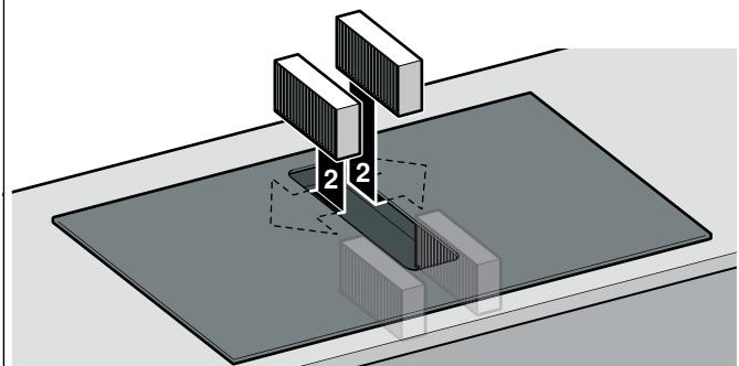
4. Colocar los otros filtros acústicos o de carbón activo en los lados izquierdo y derecho del aparato.
