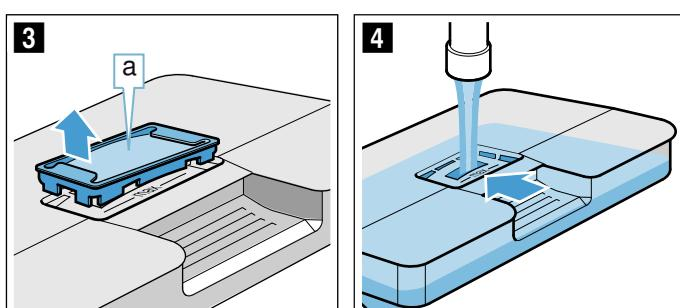
7. Знову встановіть кришку a в отвір на резервуарі для води.
