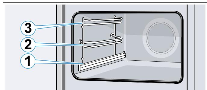
На рівнях встановлення з 2 по 3 завжди вставляйте приладдя між обома напрямними рівня встановлення.
