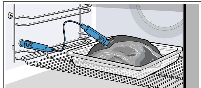
**Птиця:** Встановлюйте термометр у найтовстіше місце грудини птиці до упору. В залежності від типу птиці встановлюйте термометр поперек або уздовж. Після цього поверніть птицю грудиною донизу на решітку.
