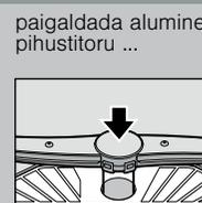
paigaldada alumine pihustitoru ...
