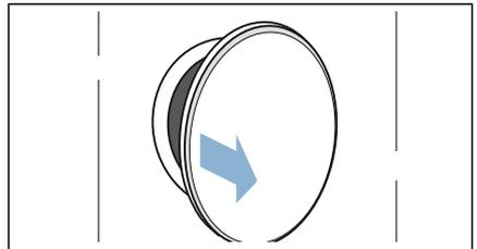
2. Senzor vlage očistite hrapavom stranom spužvice.
