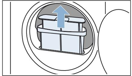
3. Uklonite niti iz filtera za niti. Pazite da niti ne dospiju u odvod.
