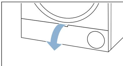
3. Odbavite ručice na poklopcu izmjenjivača temperature.
