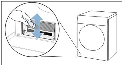
**Napomena:** Pazite da lamele izmjenjivača topline čistite odozgo prema dolje i da ih ne savijete ili oštetite.
