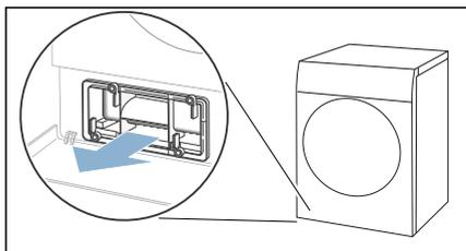
5. Oprezno skinite flis filtra s poklopca izmjenjivača topline.
