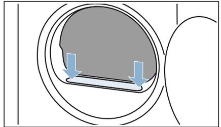
4. Razvucite dvodijelni filter za niti.
