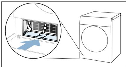
10. Klizno pomaknite poklopac izmjenjivača temperature prema unutra hvatajući ga za dršku.
