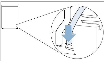
6. Pritisnite odvodno crevo u provod creva za uređaj.
