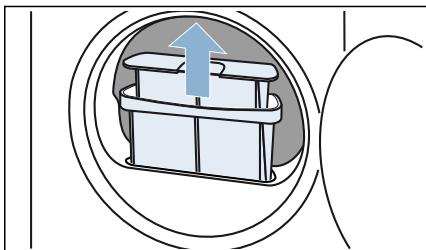
3. Vlakna uklonite iz udubljenja sita. Pazite da vlakna ne upadaju u otvoreno okno.
