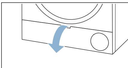
3. Lossa spaken till värmeväxlarskyddet.
