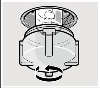
3. Remplacer l'ampoule par un modèle identique.
