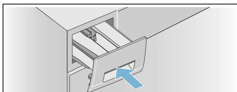
**Indicație:** Lăsați deschis sertarul pentru detergent pentru ca apa reziduală să se poată evapora.
