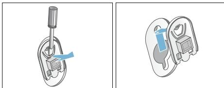
2. Montați toate cele patru manșoane. Prindeți bine cablul de alimentare de suporturi. Montați și strângeți șuruburile.
