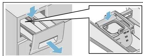
**Indicație:** Nu utilizați ajutorul pentru măsurare pentru detergenți sub formă de gel și sub formă de pulbere sau pentru programele cu prespălare, sau când timpul de programare „Programare” este selectat.
