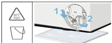
5. Deșurubați cu atenție capacul pompei; se poate scurge apă reziduală.
