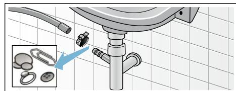
4. Montați la loc furtunul de evacuare și asigurați locul de racordare cu colierul de furtun.
