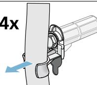
2. Scoateți cablul de alimentare din suporturi. Defiletați toate cele patru șuruburi cu manșon pentru transport.
