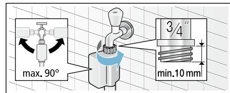
**Indicație:** Deschideți cu grijă robinetul de apă, având grijă să nu existe surgeri în punctele de raccordare. Raccordul cu filet se află sub presiunea apei din conductă.
