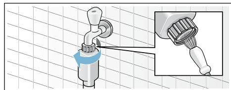
6. Pentru modelele standard și Aqua-Secure, curățați sita din partea din spate a aparatului:
