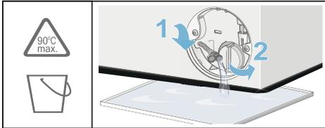
5. Pumpendeckel vorsichtig abschrauben, Restwasser kann auslaufen. Innenraum, Gewinde des Pumpendeckels und Pumpengehäuse reinigen. Das Flügelrad der Laugenpumpe muss sich drehen lassen. Pumpendeckel wieder einsetzen und verschrauben. Griff muss senkrecht stehen.
