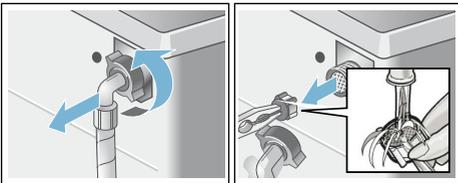
7. Sieb einsetzen, Schlauch anschließen und auf Lecks prüfen.
