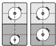
De främre och bakre kokzonen har 2 induktorer var som går att använda oberoende av varandra. Ställ in det effektläge du vill ha på resp. kokzon. Använd bara en gryta på varje kokzon.
