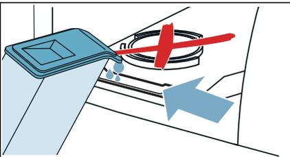
**Hinweis:** Wenn Sie mehr als 180 ml Trinkwasser in das Gerät gießen und im Display ☹️ nicht erlischt, wurde das Trinkwasser in die falsche Einfüllöffnung gegossen oder das Gerät nicht korrekt ausgerichtet. Gießen Sie das Trinkwasser in die vordere Einfüllöffnung oder richten Sie das Gerät korrekt aus. → "Gerät aufstellen" auf Seite 13
