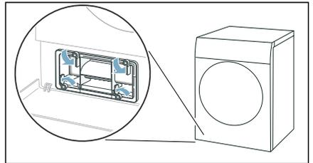
3. Wärmetauscher-Abdeckung am Griff herausziehen.
