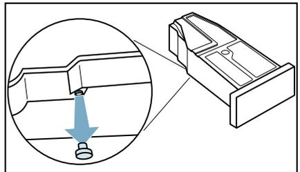
9. Kondenswasser-Behälter wieder um 180° drehen und den Stöpsel in die Vertiefung an der Oberseite des Kondenswasser-Behälters setzen.
