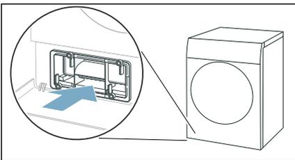
**Hinweis:** Sie können die Wärmetauscher-Abdeckung nur einschieben, wenn sich das Flusendepot im Gerät befindet.
