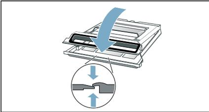
**Hinweis:** Achten Sie darauf, dass Sie das Flusendepot vollständig verschließen.
