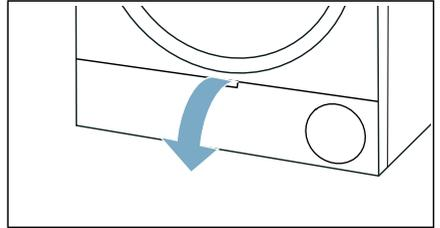
2. Hebel der Wärmetauscher-Abdeckung entriegeln.
