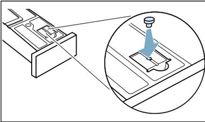
10. Den Kondenswasser-Behälter bis zum Einrasten einschieben.
