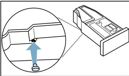
3. Sieb im Kondenswasser-Behälter reinigen. → Seite 48
