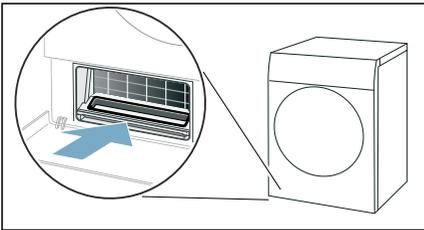
**11.** Wärmetauscher-Abdeckung am Griff einschieben.
