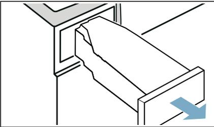
2. Das Sieb entnehmen und unter fließendem Wasser oder in der Geschirrspülmaschine reinigen.
