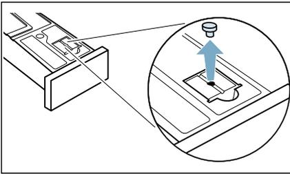
2. Kondenswasser-Behälter um 180° auf die Unterseite drehen und den Stöpsel einsetzen.
