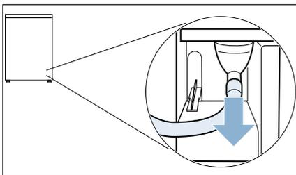
**Указание:** В състоянието на доставка на уреда маркучът за кондензатна вода е закрепен върху накрайника.
