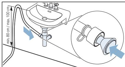
Мястото на свързване трябва да бъде подсигурено с халка за закрепване на тръба (диапазон на захват 12-22 мм, от търговската мрежа).
