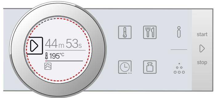
Wenn die Dauer beendet ist, ertönt ein Signal. Das Gerät hört auf zu heizen. Im Display steht die Dauer 00m 00s.
