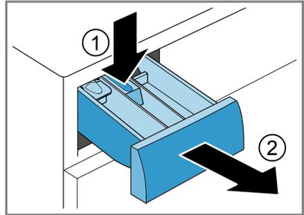
3. Izvadite umetak povlačenjem odozdo prema gore.
