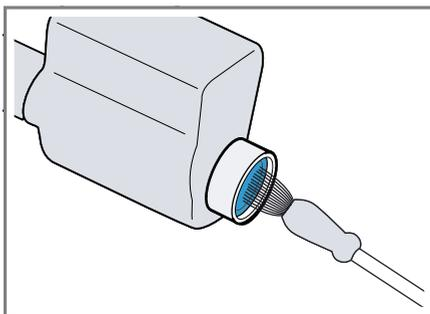
3. Priključite dovodno crijevo za vodu i provjerite je li dobro zabrtvljeno.
