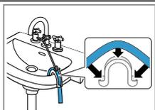
Odvod u plastičnu cijev s gumenom spojnicom ili u slivnik.
