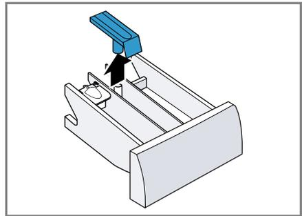
4. Ladicu za deterdžent i umetak očistite vodom i četkom te obrišite.
