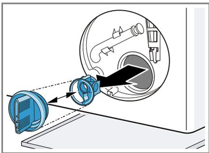
2. Očistite unutarnji prostor, navoj na poklopcu crpke te kućište crpke.
