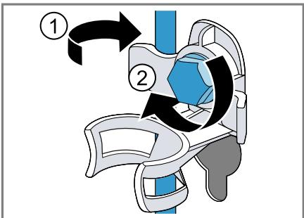
**5. Τοποθετήστε τον εύκαμπτο σωλήνα στο στήριγμα.**
