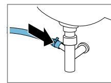
Ασφαλίστε το σημείο σύνδεσης με έναν σφιγκτήρα εύκαμπτου σωλήνα (24-40 mm).
