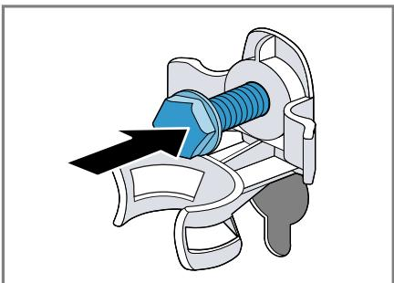
**4. Τοποθετήστε το καλώδιο σύνδεσης στο στήριγμα ① και σφίξτε και τις 4 βίδες των ασφαλειών μεταφοράς με ένα κλειδί SW13②.**
