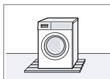
Collocare l'apparecchio su una base di legno resistente all'acqua ben fissata al pavimento. Lo spessore della base di legno deve essere di almeno 30 mm.
