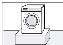
Fissare l'apparecchio con delle linguette di fissaggio → *Pagina 33.*
