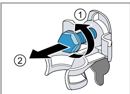
3. Die Netzanschlussleitung aus der Halterung ziehen.
