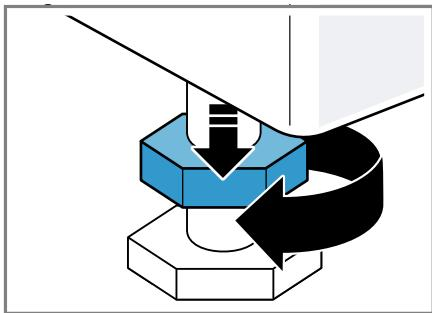
2. Um das Gerät auszurichten, die Gerätetfüße drehen. Die Ausrichtung mit einer Wasserwaage prüfen.
