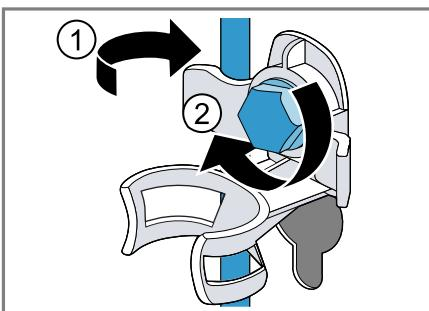
5. Den Schlauch in die Halterung einsetzen.
