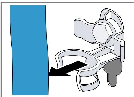
2. Alle Schrauben der 4 Transportsicherungen mit einem Schraubenschlüssel SW13 lösen ① und entfernen ②.
